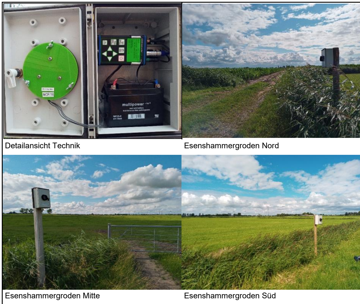
Abb. 7: Aufbau der batcorder-Technik im UG Windpark Esenshammergroden 2021
